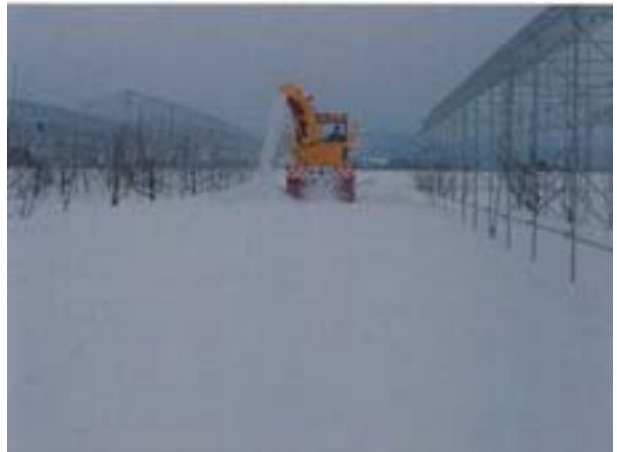
作業中（中型ロータリ除雪車）
